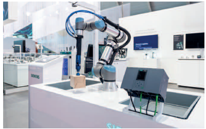
Simatic Robot Pick AI ist eine Bildverarbeitungssoftware für Roboter-Lösungen auf Basis des maschinellen Lernens (Bild: Siemens)
